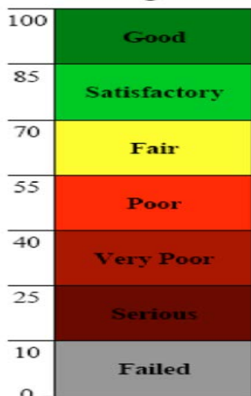
Слика 6. PCI градација стања коловоза (6) Слика 7. Динамичка сегрегација у ГИС софтверу (7)
