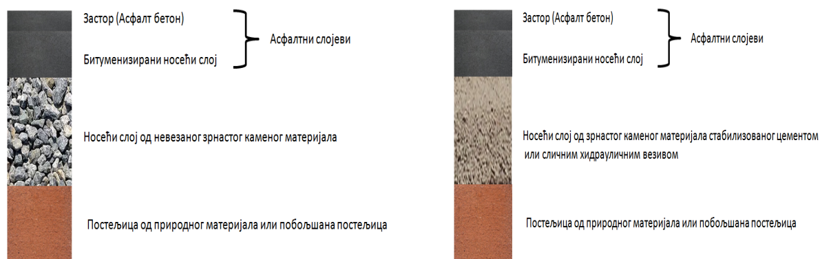
Слика 3. Примјер флексибилне (лијево) и полукруте (десно) коловозне конструкције (З, СПРС У.Ц4.012.)
